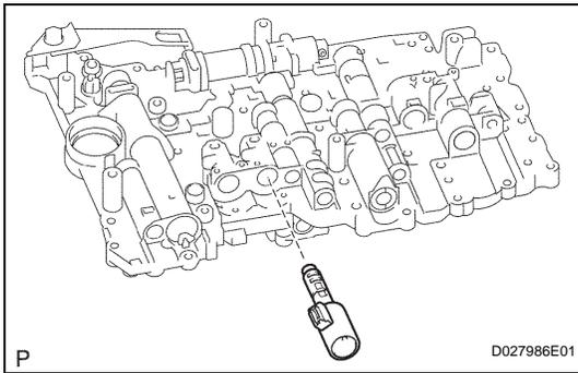
**3. INSTALL SHIFT SOLENOID VALVE SL1**
