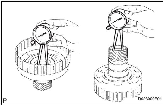
**2. INSPECT REVERSE CLUTCH HUB SUB-ASSEMBLY**
