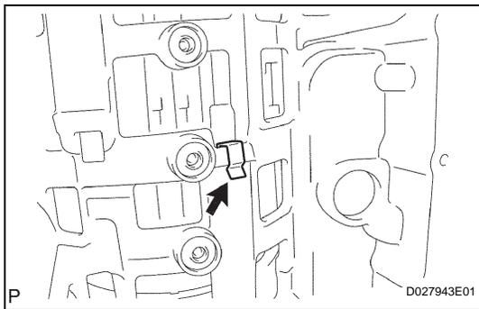
**9. INSTALL BRAKE PLATE STOPPER SPRING**
