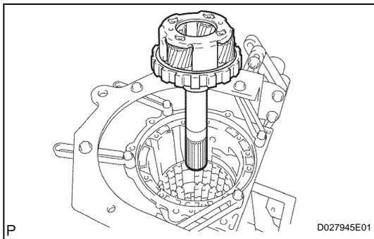
(d) Install the rear planetary gear assembly.
