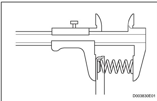
**8. INSPECT BRAKE PISTON RETURN SPRING SUB-ASSEMBLY**
