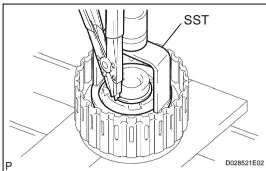
**14. REMOVE NO. 1 CLUTCH BALANCER**
