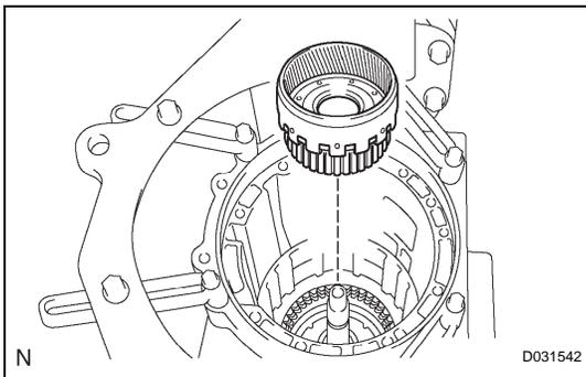
**21. INSTALL FRONT PLANETARY RING GEAR**
