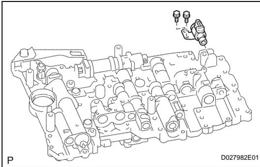
**2. REMOVE SHIFT SOLENOID VALVE SR**
