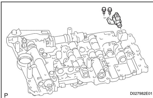
**7. INSTALL SHIFT SOLENOID VALVE SR**
