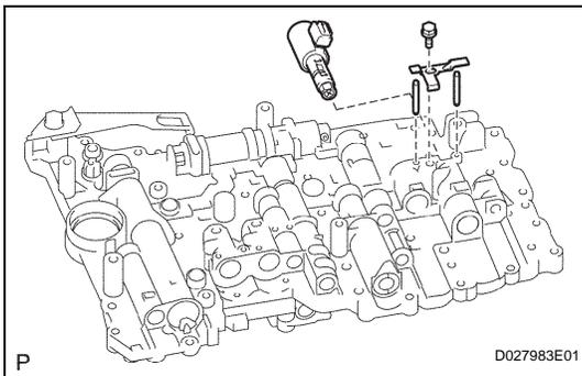
**6. INSTALL SHIFT SOLENOID VALVE SLU**
