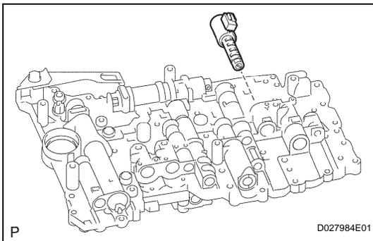
**4. REMOVE SHIFT SOLENOID VALVE SL2**
