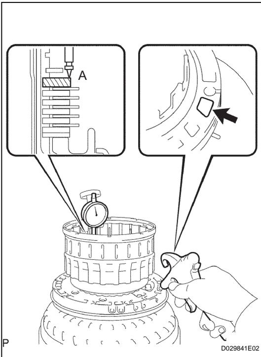
**9. INSPECT PACK CLEARANCE OF DIRECT CLUTCH**
