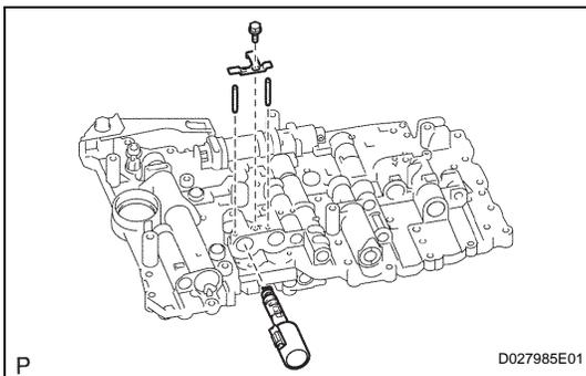
**5. REMOVE SHIFT SOLENOID VALVE SLT**
