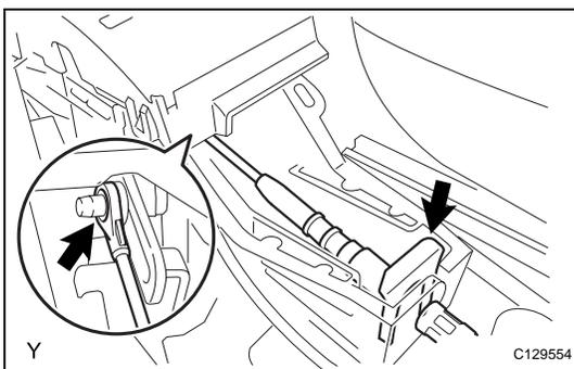
2. **CONNECT TRANSMISSION CONTROL CABLE ASSEMBLY**
