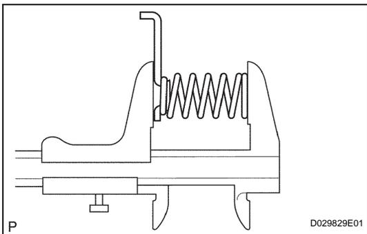
**10. INSPECT NO. 2 BRAKE PISTON RETURN SPRING SUB-ASSEMBLY**
