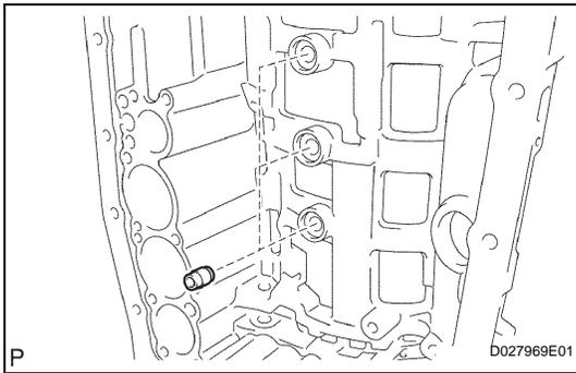
**44. INSTALL BRAKE DRUM GASKET**
