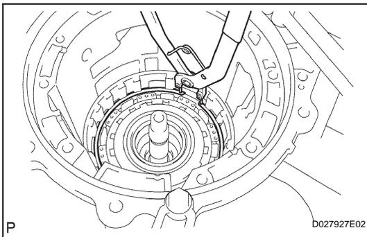
**27. INSTALL 2ND BRAKE PISTON HOLE SNAP RING**
