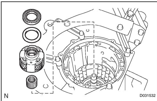
**13. INSTALL CENTER PLANETARY GEAR ASSEMBLY**
