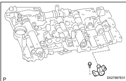
**2. INSTALL SHIFT SOLENOID VALVE S1**
