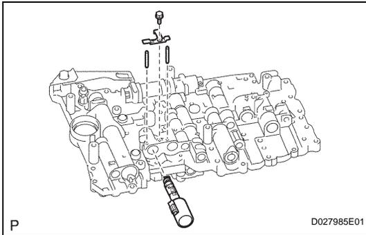
**4. INSTALL SHIFT SOLENOID VALVE SLT**
