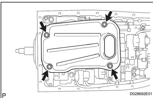
**3. INSTALL VALVE BODY OIL STRAINER ASSEMBLY**
