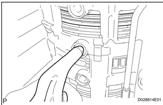
**23. INSPECT NO. 1 PISTON STROKE OF BRAKE PISTON**
