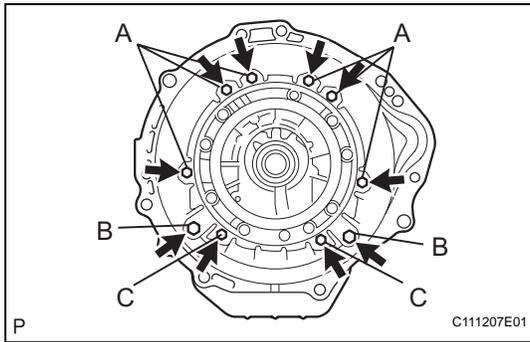
**54. INSTALL AUTOMATIC TRANSMISSION HOUSING**
