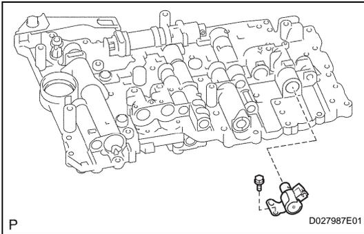
**7. REMOVE SHIFT SOLENOID VALVE S1**
