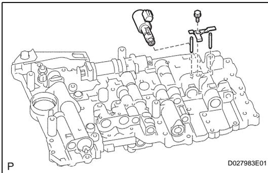
**3. REMOVE SHIFT SOLENOID VALVE SLU**
