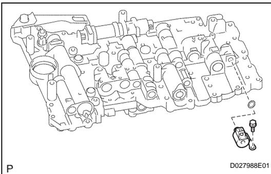
**REASSEMBLY****1. INSTALL SHIFT SOLENOID VALVE S2**
