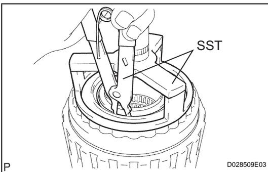
**20. REMOVE NO. 3 CLUTCH BALANCER**
