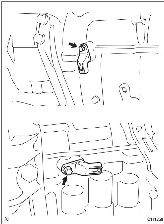
**56. INSTALL TRANSMISSION REVOLUTION SENSOR**
