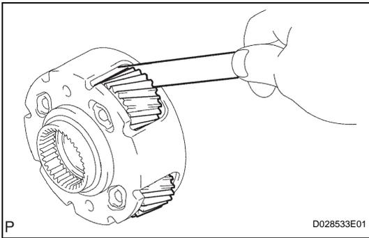
**11. INSPECT CENTER PLANETARY GEAR ASSEMBLY**
