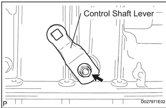
**59. INSTALL TRANSMISSION CONTROL SHAFT LEVER LH**
