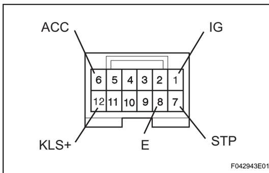
4. **INSPECT SHIFT LOCK CONTROL ECU SUB-ASSEMBLY**
