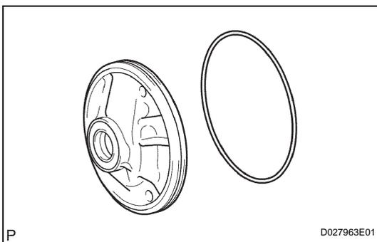
**5. REMOVE FRONT OIL PUMP BODY O-RING**
