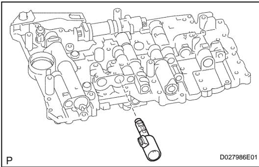
**6. REMOVE SHIFT SOLENOID VALVE SL1**
