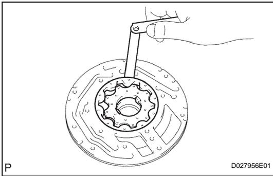
**3. INSPECT CLEARANCE OF OIL PUMP ASSEMBLY**
