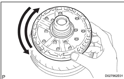
**4. INSPECT FRONT OIL PUMP DRIVE GEAR ROTATION**
