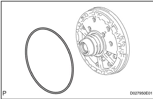
**1. REMOVE FRONT OIL PUMP BODY O-RING**
