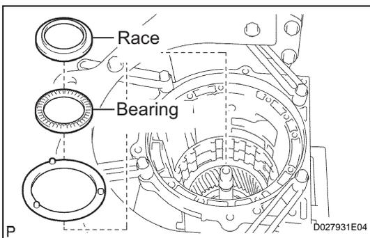
**22. INSTALL FRONT PLANETARY GEAR ASSEMBLY**
