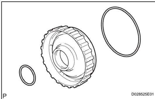
**12. INSTALL NO. 1 CLUTCH BALANCER**
