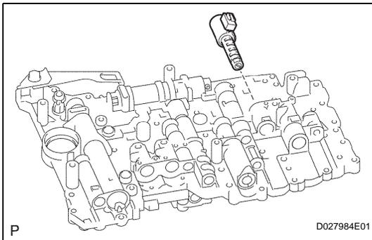
**5. INSTALL SHIFT SOLENOID VALVE SL2**
