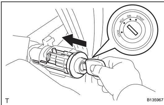
3. **INSTALL IGNITION SWITCH LOCK CYLINDER AND KEY SET**
