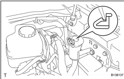
**4. REMOVE WIRELESS DOOR LOCK BUZZER**
